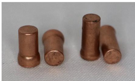
Ein Grundelement der Pressverbindungstechnik ist die im Fließpressverfahren hergestellte Hülse aus Kupfer. Die Hülse ist einseitig geschlossen und am Eingang zur Erleichterung der Drahteinführung trichterförmig erweitert. Der Innenraum ist mindestens bis zu 1/3 mit Antioxid – Kontaktpaste gefüllt.
